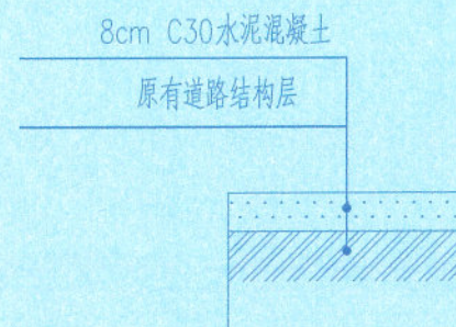
路側出入口混凝土翻挖新建
