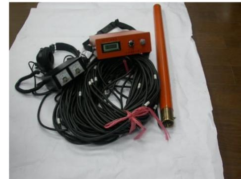
图 3.2.2-5 CCT-4 型磁探仪
