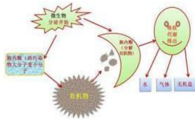
图6 底泥原位修复原理图
