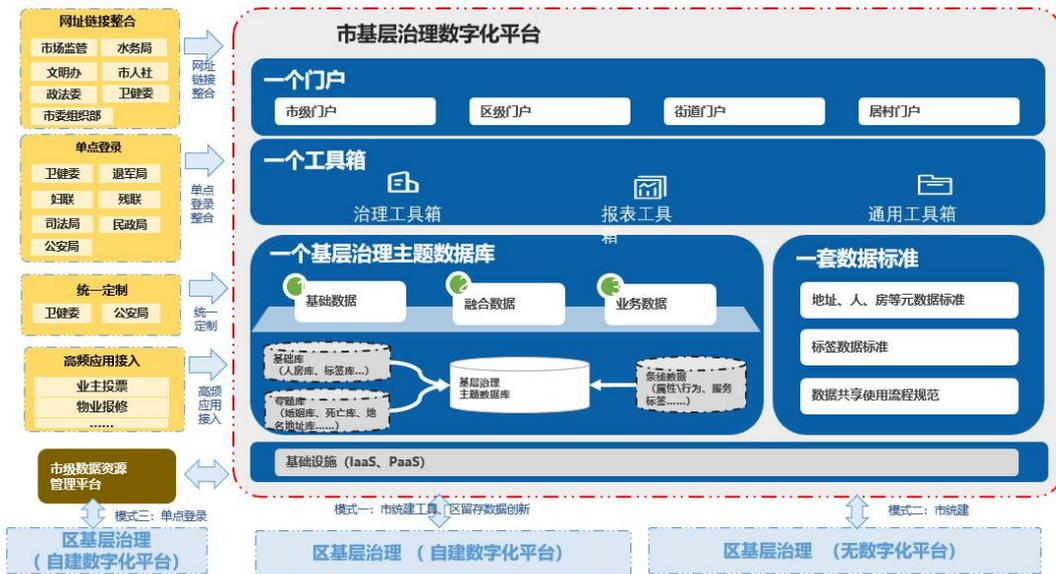
此平台依托上海市电子政务云平台进行分区部署，在云平台的电子政务外网区、互联网区分别搭建上海市基层治理数字化平台。接入单位根据自身网络条件进行访问。上海市基层治理数字化平台WEB服务器、应用服务器和数据库服务器部署在电子政务外网区，在互联网区部署前置服务器，存放页面静态资源。电子政务外网和互联网两区通过政务云平台的安全隔离设施有限访问。不同的访问对象通过不同的网络环境进行访问。
