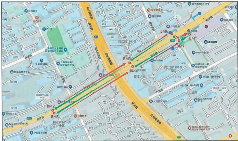
图41 轨行区基准点联测路线示意图
