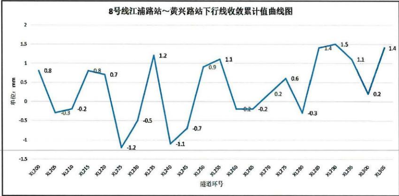
图29 8号线黄兴路站~江浦站下行线累计收敛曲线
