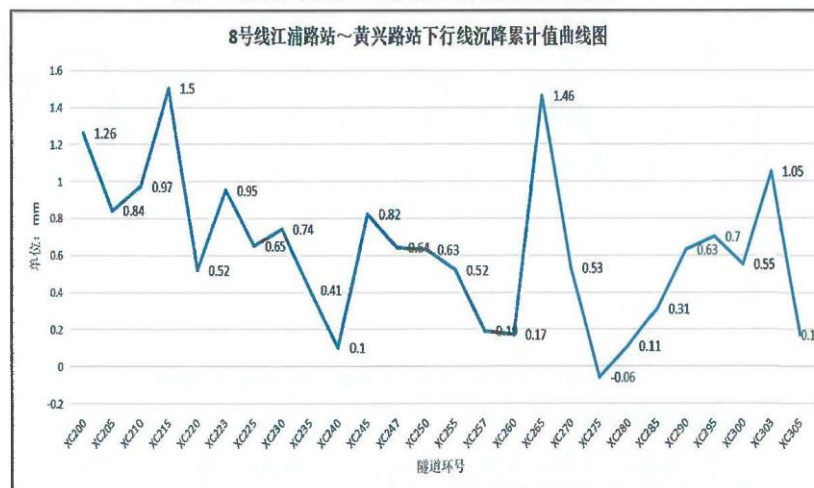
图27 8号线黄兴路站~江浦路下行线累计沉降曲线
