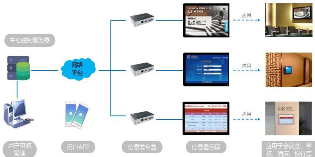
信息发布系统系统架构图
