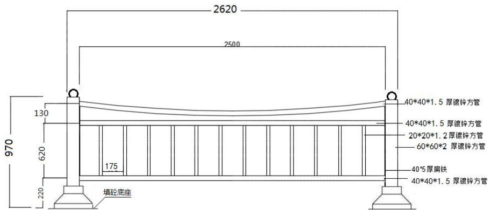
材质：镀锌方管 颜色：黑色 规格：2620 mm\* 970 mm 单位：毫米 (mm)
