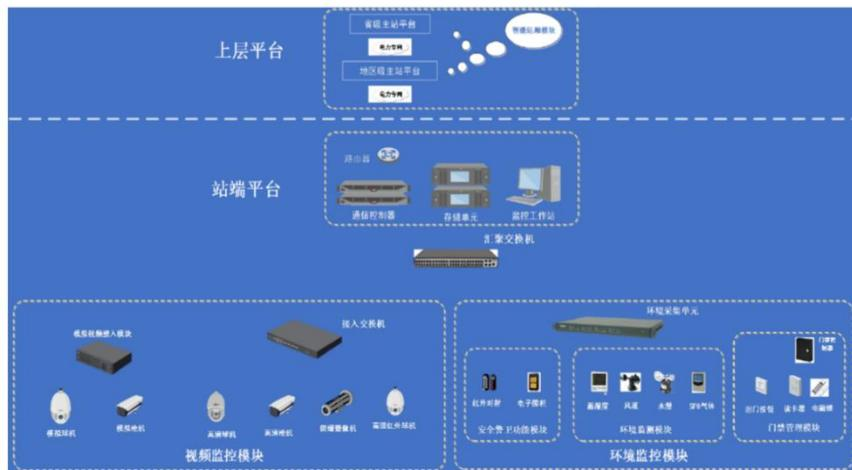
图-机房动环系统架构示意图
