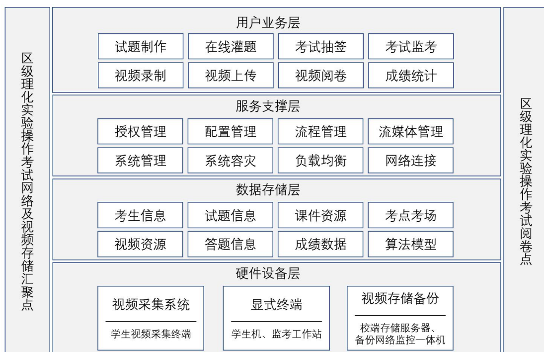
理化实验系统逻辑架构图
