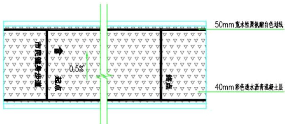
图件 1-5 透水沥青混凝土健身步道参考平面图（单向标准段）
