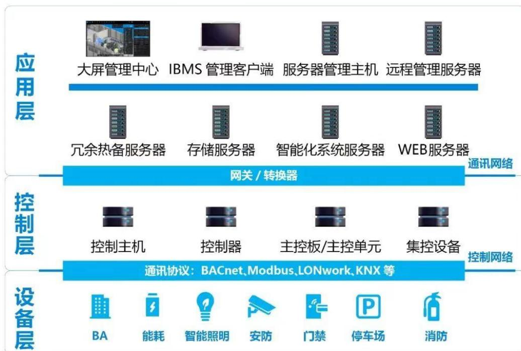
中心层主要由数据库服务器、应用服务器、管理工作站、监控大屏、维护工作站、远程管理设备、打印设备等组成，部署于网络机房内，其中数据库服务器用于为平台提供数据服务，实现数据存取与更新管理、数据完整性和数据安全性管理等功能，采用主备冗余方式设置；应用服务器为平台应用程序提供对系统资源的访问机制，需配置多种可扩展和容错技术，采用主备冗余方式设置。管理工作站、监控大屏和打印设备部署于智能化/安防控制室内，其中管理工作站用于操作员对园区业务及双碳管理平台的各子系统进行监视和控制，全部工作站支持双屏/三屏显示，其他相关人员可使用远程管理设备通过 Web 接口接入平台进行浏览和监控；监控大屏用于按区域划分安防、楼控、消防、广播等平台整合后的数据展示；维护工作站智能化/安防控制室内，用于处理智能化信息集成平台维护管理使用；打印设备用于实时打印相关信息。
